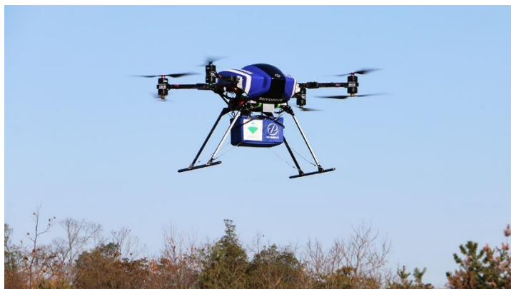
図 4-35 30kg の資材を運搬可能なドローン
