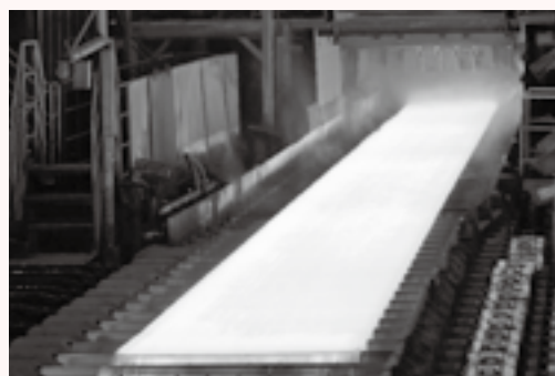
熱間圧延 (NCHミル) での圧延イメージ
