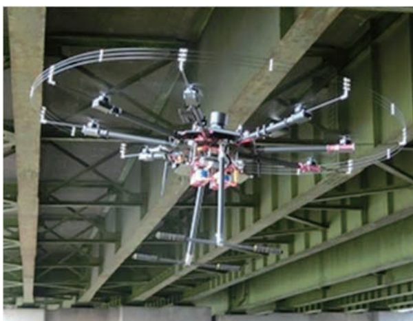
上向き撮影用ドローンによる 橋梁下面の撮影状況
