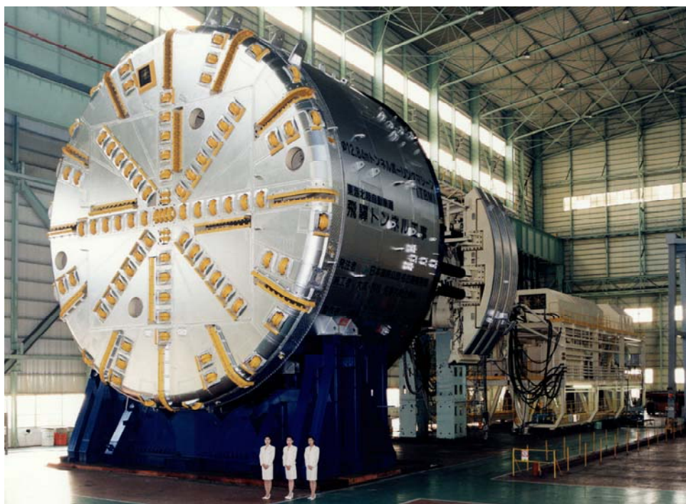
東海北陸自動車道 飛驒トンネル(本坑) TBM
